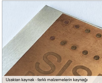
Uzaktan kaynak - farklı malzemelerin kaynağı
