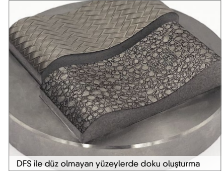
DFS ile düz olmayan yüzeylerde doku oluşturma
